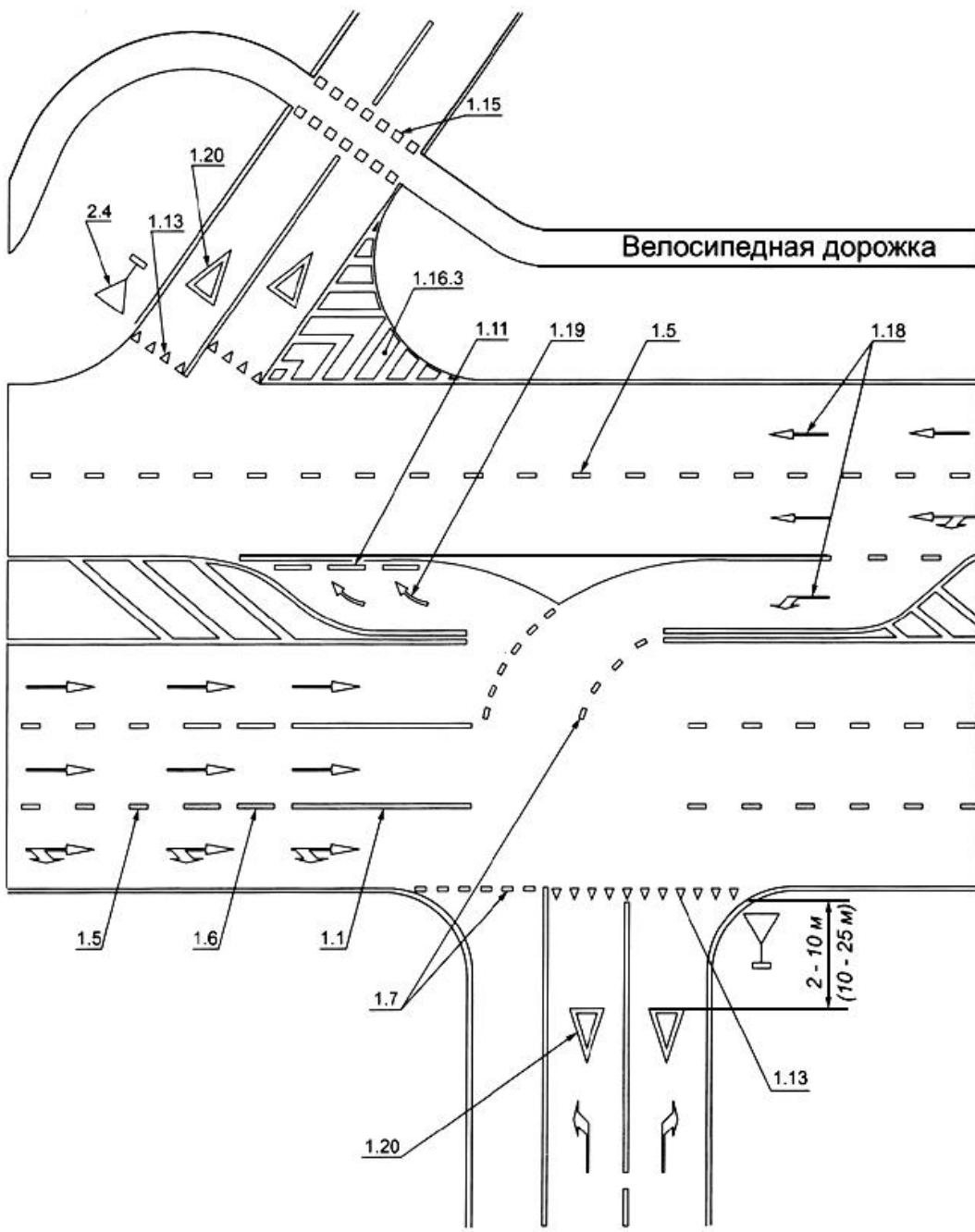
Рисунок В.10 - Пример нанесения разметки канализированного пересечения
