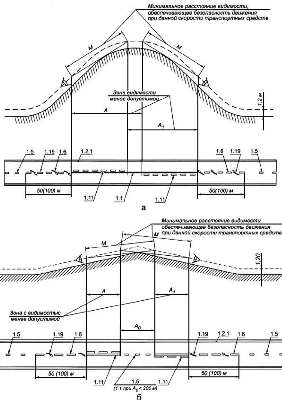
Рисунок В.6 - Примеры нанесения разметки на участках дорог с необеспеченной видимостью, где зоны видимости встречного автомобиля: а - перекрываются; б - не перекрываются
