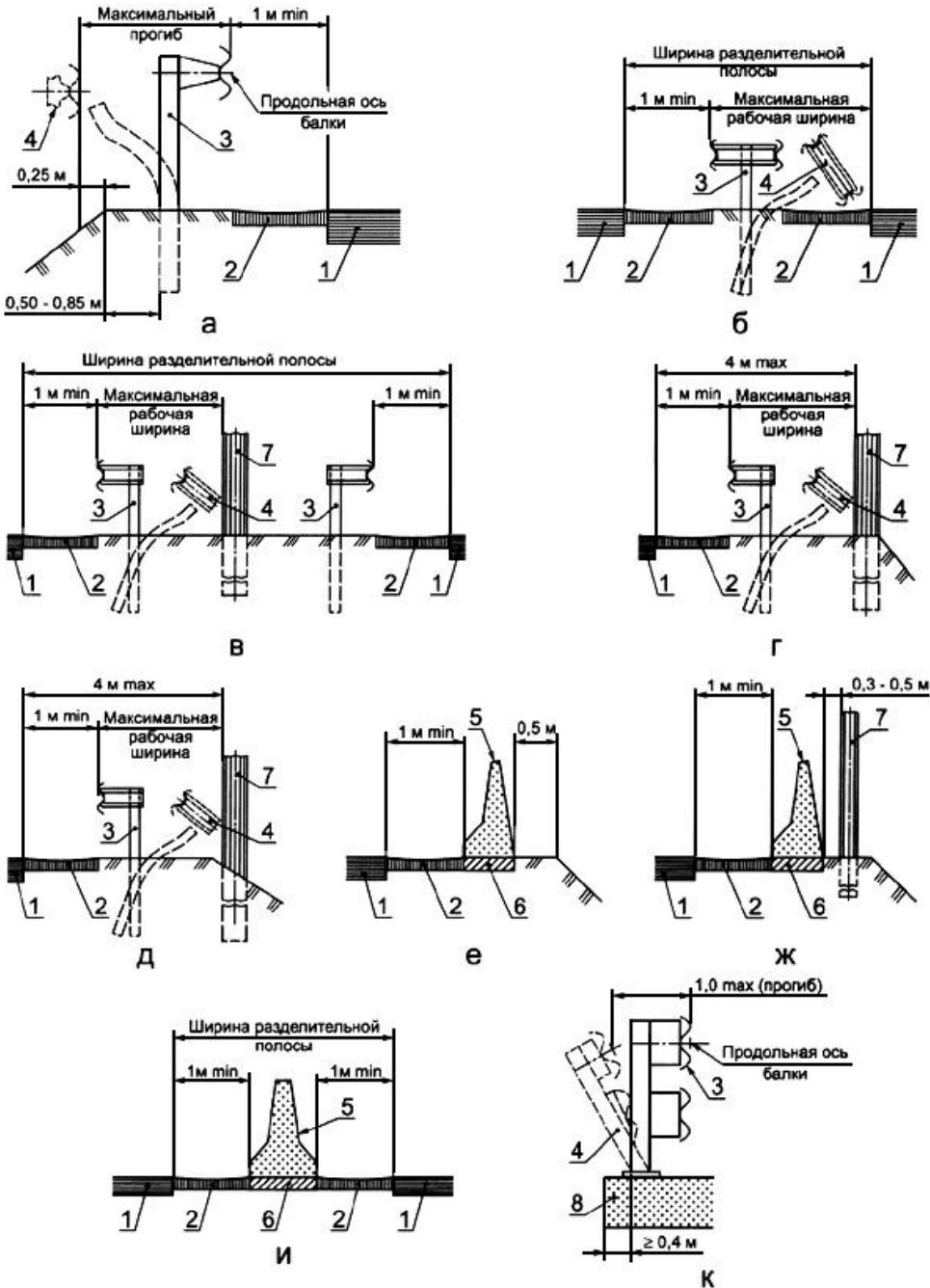
1 - проезжая часть; 2 - укрепительная полоса; 3 - недеформированное барьерное ограждение; 4 - деформированное барьерное ограждение; 5 - парапетное ограждение; 6 - основание ограждения; 7 - массивная опора; 8 - плита мостового сооружения
