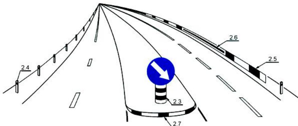
Рисунок В.22 - Пример нанесения разметки 2.3-2.7
