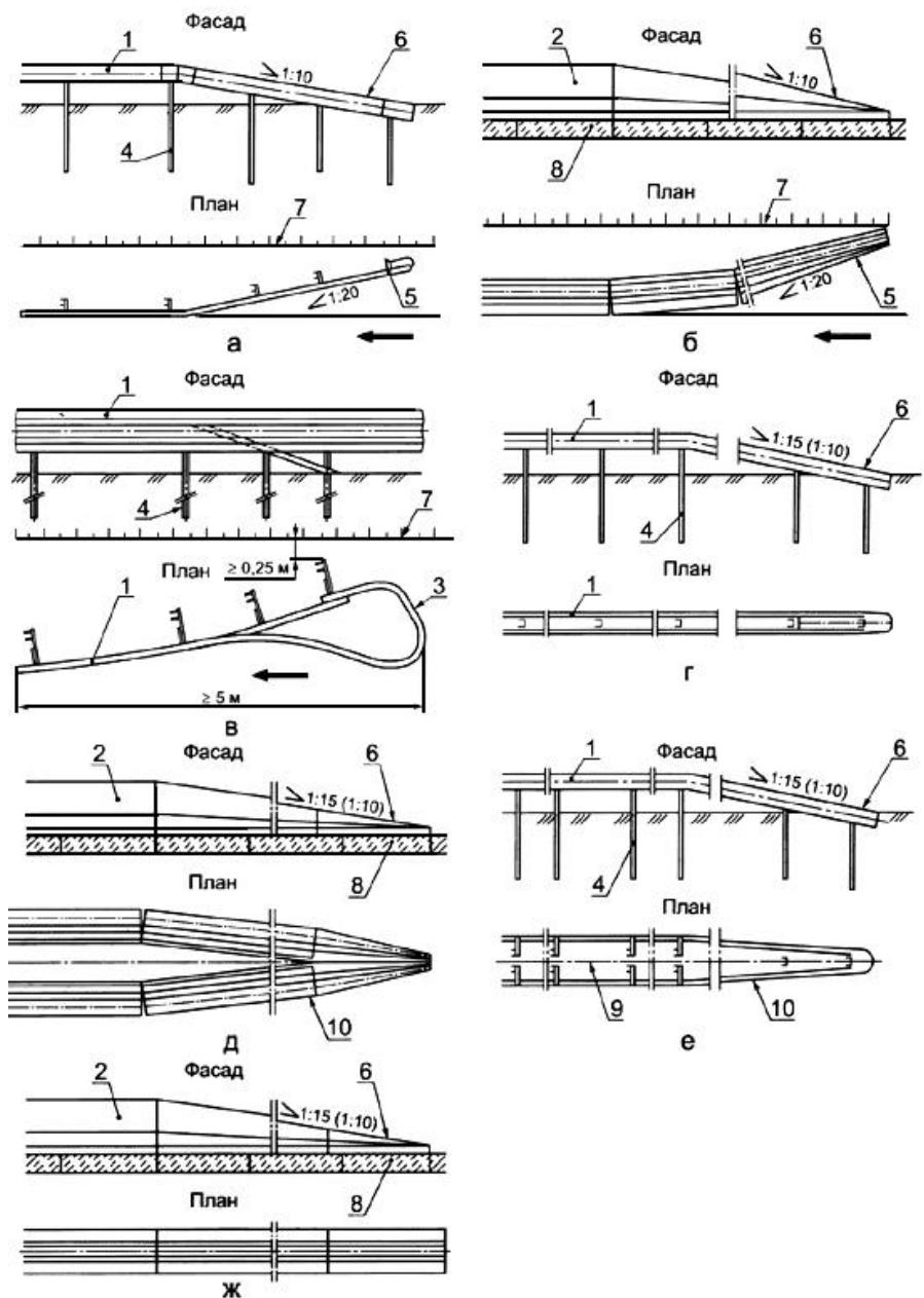
1 - барьерное ограждение; 2 - парапетное ограждение; 3 - изгиб ограждения; 4 - стойка ограждения; 5 - отгон ограждения; 6 - понижение ограждения на начальном и конечном участках; 7 - бровка земляного полотна; 8 - основание; 9 - ось разделительной полосы; 10 - сближение рядов ограждения с осью разделительной полосы; ← - направление движения транспортных средств
