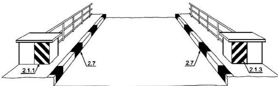
Рисунок В.21 - Пример нанесения разметки 2.1.1, 2.1.3 и 2.7
