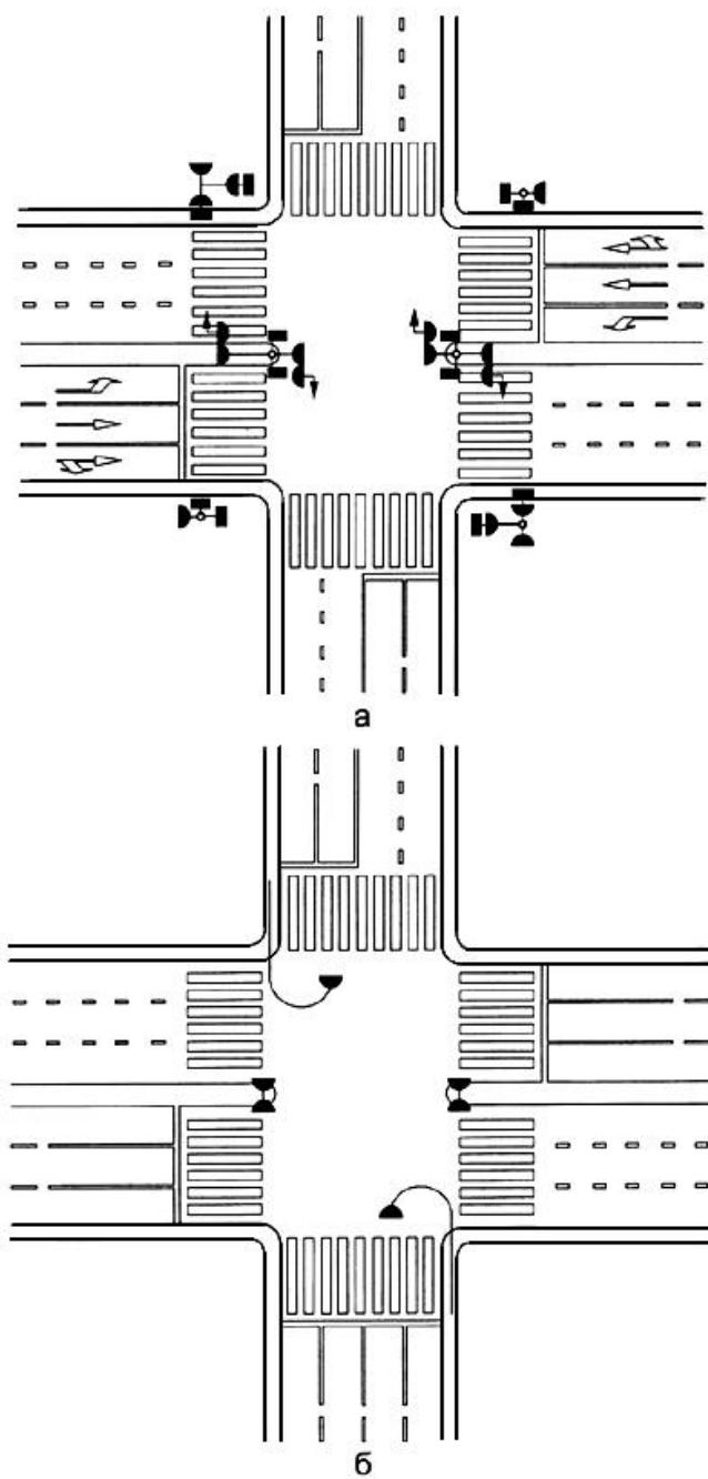
Рисунок В.24 - Пример размещения светофоров: а - на перекрестке; б - на разделительной полосе и над проездной частью
